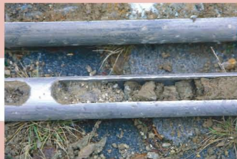
Rammkernsonden nach der Sondierung, gefüllt mit unterschiedlichen Bodenarten aus unterschiedlichen Bodentiefen
