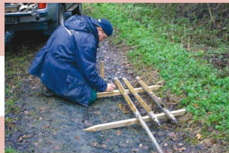
Dipl. Geologe Harald Dostmann bei der Aufnahme der Bohrprofile und Schichtenverzeichnisse bei der Baugrunderkundung
