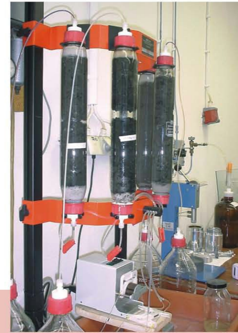
Bestimmung der Wasserdurchlässigkeit von Geotextilen Dichtungsbahnen (Bentonimatten) im Triaxialprüfstand
