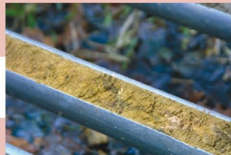
Rammkernsonden nach der Sondierung, gefüllt mit unterschiedlichen Bodenarten aus unterschiedlichen Bodentiefen
