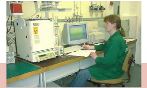
Analytik von Bodenproben auf Gehalt von Pflanzenschutzmitteln mit Gaschromatograph, im Bild Laborantin Kerstin Grund
