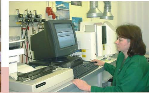
Analytik von Bodenproben auf Schwermetallgehalt mit Atomabsorptionsspektrometer, im Bild Laborantin Ilona Schulz
